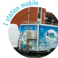
Réparties sur l'ensemble de la Picardie, les 16 stations fixes de surveillance mesurent en continu les concentrations des polluants atmosphériques. Ce dispositif est complété par 1 station mobile, déplacée sur tout le territoire pour des mesures ponctuelles, ainsi que par des préleveurs et des tubes passifs.
