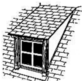
lucarne rampante ou en chien couché
