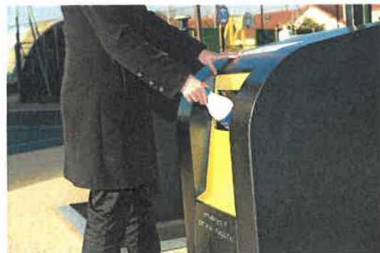
Conteneur enterré multimatériaux
