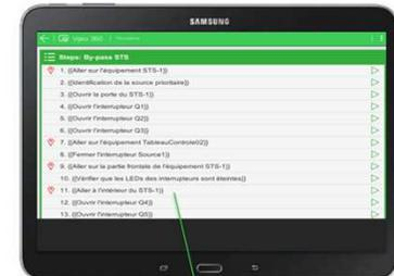
Des procédures de maintenance sont disponibles et permettent de guider l'opérateur dans les interventions ou la résolution des pannes.
