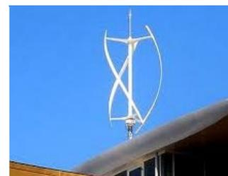
Exemple d'éolienne sur mat à axe verticale
